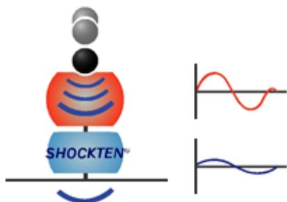
Utilisation d'un appareil vibrant sur matériau SHOCKTEN® amorti situé entre l'appareil et la structure rigide. Dans cette configuration, avec le SHOCKTEN® les vibrations (Chocs) transmises vers la structure rigide sont significativement réduites.
