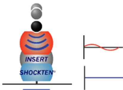
Utilisation d'un appareil vibrant sur matériau SHOCKTEN® amorti équipé d'un insert adhésif et fixé sur structure rigide. Dans cette configuration, la transmission de forces est quasiment nulle. L'insert adhésif, permet au SHOCKTEN de stopper les mouvements vibratoires.
