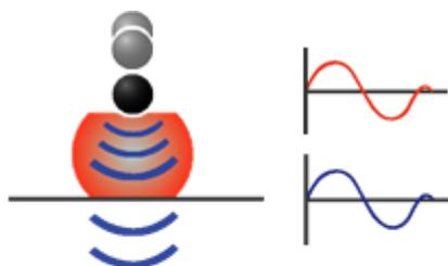
Utilisation d'un appareil vibrant sur structure rigide avec liaison directe. L'impact sur la structure est très forte et courte. La majorité des forces qui traversent la machine est transférée sur la structure à l'exception de ce qui est absorbé par la machine.
